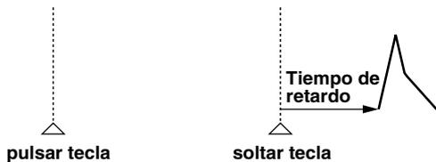
**KEY-OFF-DECAY:** El Tone no sonará mientras la tecla esté pulsada, pero si lo hará después del Tiempo de Retardo especificado cuando la tecla se libere. Sin embargo, para este ajuste – no como para KEY-OFF-N – el envolvente TVA del Tone empezará cuando se pulse la primera tecla. Por eso, en la mayoría de casos, sólo se escuchará la parte de bajada del sonido.
