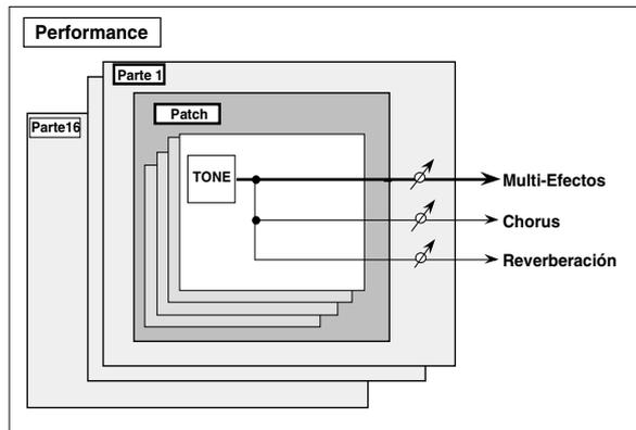
**Fig.2 – La Salida está ajustada a “PATCH” en el modo Performance (los ajustes de salida para el Tono son válidos)**
