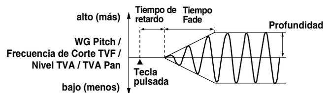
**ON-OUT:**El LFO se aplicará inmediatamente cuando se pulsa la tecla, y luego se producirá un fundido de salida.
