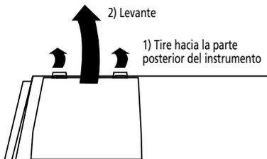
3. Extraiga el compartimiento de las baterías e introduzca las seis baterías (tres a cada lado).
