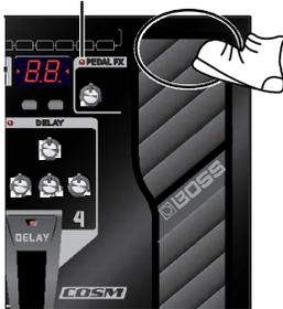
Pise firmemente la punta del pedal de expresión (apoyando algo de peso sobre el mismo) para cambiar la función del pedal.
