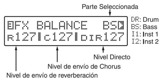
4. Pulse [PART SELECT] para seleccionar la Parte cuyos ajustes desea cambiar.
