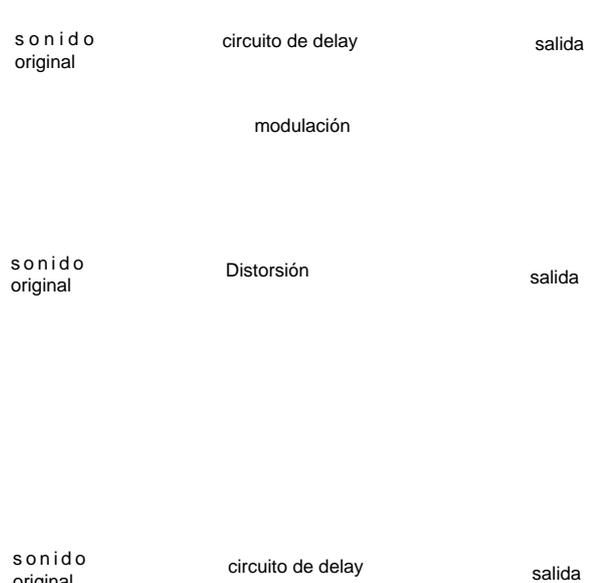
Los efectos pueden ser de dos tipos generales: los que modifican la estructura de los armónicos (parciales) para modificar el sonido original en sí y los que añaden sonido adicional al sonido original.
