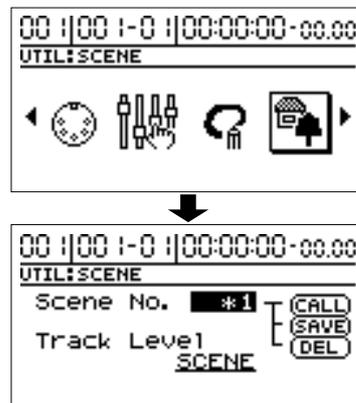
3. Use [CURSOR] para mover el cursor a “Track Level,” y use el dial TIME/VALUE para seleccionar “FADER.”
