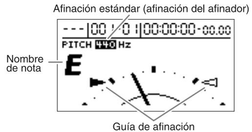
Si la diferencia entre la altura de la nota de entrada y la altura correcta de la nota es menor que +/-50 centésimas, la guía de afinación indicará el valor de la diferencia. Observe la guía de afinación, y afine su instrumento hasta que ambos indicadores izquierdo y derecho se iluminen. Además de la Guía de Afinación, el BR-1180/1180CD también tiene la opción de afinación analógica tradicional en pantalla.
